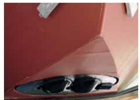
Position des Bugstrahl-Kugelradantriebes im Bug des Schiffsrumpfes Bild: WSM
