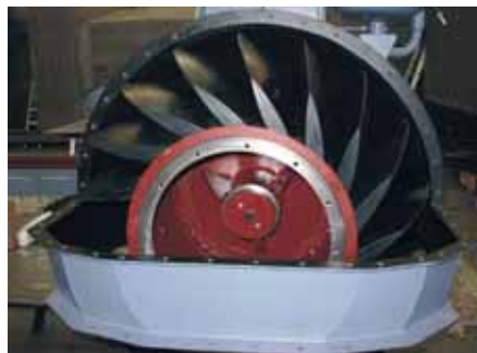
Zum Auswechseln einzelner Zähne kann im Havariefall das Gehäuse des Kugelradantriebes im Schiff von oben geöffnet werden Bild: delphin-tec
