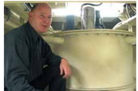
Stefan Freise inspiziert den Kugelradantrieb an Bord der neuen SPREEBLICK III. Als Antrieb dient ein Elektromotor, der von oben angeflanscht ist Bild: Herms-Ricken
