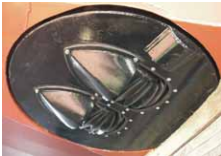
Durch die geschützte Anordnung kann der um 240° drehbare Kugelradantrieb sowohl als Querstrahlruder als auch zum Vortrieb wirken
