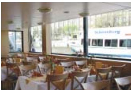
Die 1,40 m hohen getönten Sicherheits-Isolierglasfenster von Alux-Luxar bieten für die Passagiere ein breites Sichtfeld auf die Sehenswürdigkeiten am Ufer Bild: Ricken
