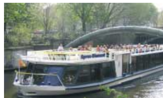
Das FGS „Spree Diamant“ wurde nach ihrer Taufe am 15. April in Berlin in Betrieb genommen. Es wurde als erstes Fahrgastschiff Europas in Doppel-Rumpfbauweise gebaut, was höchste Sinksicherheit garantiert.
