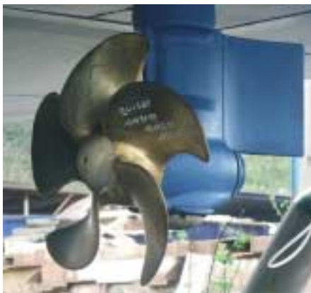
Der Schottel – Ruderpropeller Typ SRP 110 gibt der Spree Diamant auf den engen Berliner Wasserstraßen die notwendige Manövrierfähigkeit Bild: Guddat
