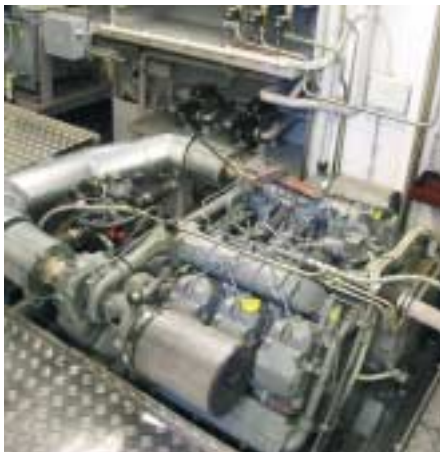
Der 246 kW Deutz BF 6 MC 1015 Hauptantrieb ist dank der guten Schallschutzisolierung des Maschinenraumes im Fahrbetrieb an Deck kaum zu hören Bild: Ricken
